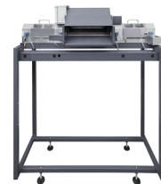
Sortierstrecke ohne Kastenrollenbahn
