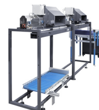
Sortierstrecke mit zwei Sortiermodulen & Kastenrollenbahn
