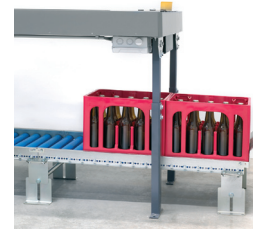
Kastenrollenbahn mit Endanschlag & Flaschensammeltisch
